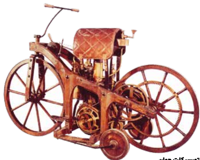
نخستین موتورسیکلت جهان موتورسیکلت مدل ۱۸۸۵ دایملر، چرخ‌هایی داشت که از یک نوار آهنی گرداگرد آن و پره‌های چوبی در وسط ساخته شده بود. این وسیله، دو چرخ کوچک متصل به فنر هم داشت که در دو طرف آن قرار داشتند و به پایداری بیشتر آن در هنگام حرکت کمک می‌کردند.
